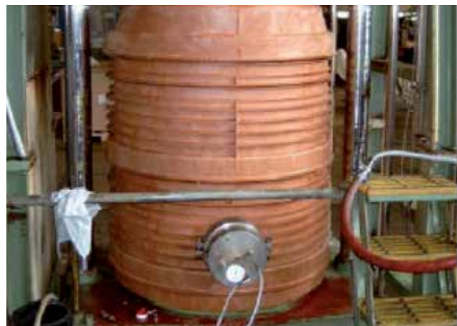
Přetlaková zkouška sestavy
